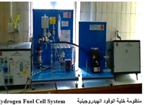
منظومة خلية الوقود الهيدروجينية Hydrogen Fuel Cell System
